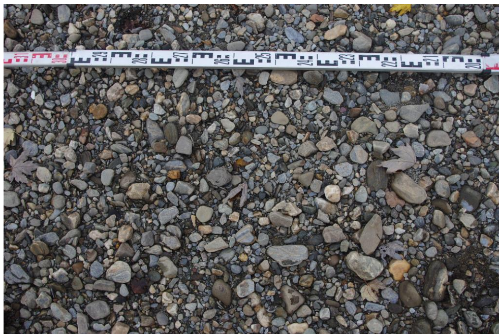
Photo 5 En aval du pont de la route 165, le substrat est principalement composé de gravier et de sable.
